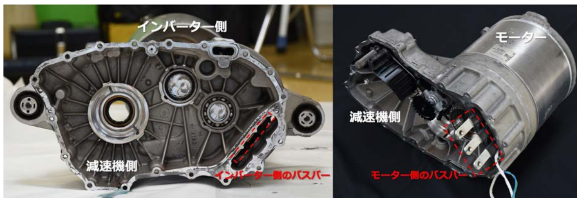
図2-2-2-1 テスラ モデルSの駆動ユニット内でのバスバーの配置
