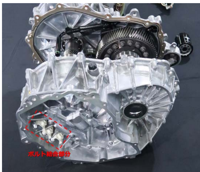
図2-2-1-2 Tesla モデル3の駆動ユニットの電気接続するための結合部分
