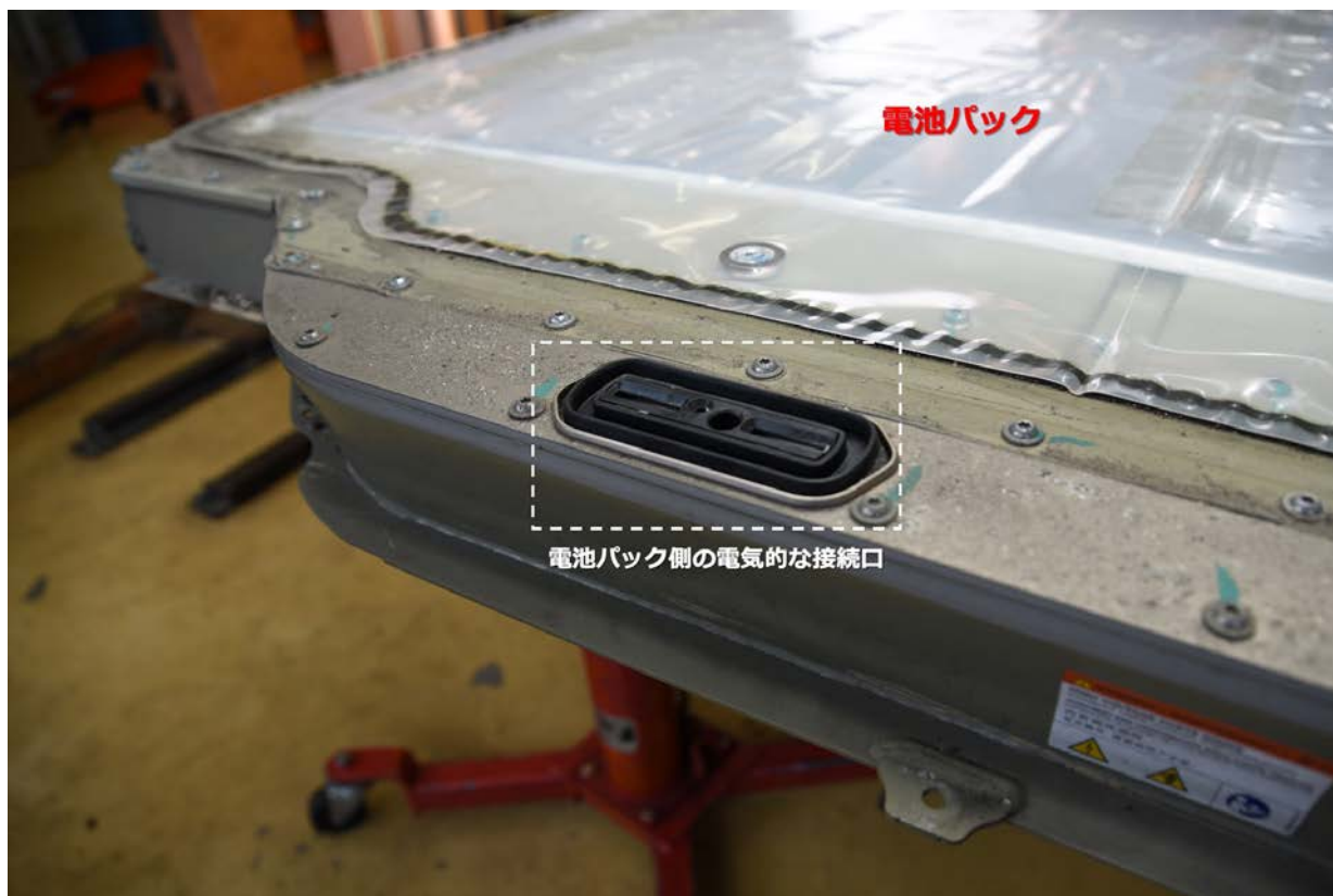
図2-2-2-4 モデルSの電池パック側の電気的な接続口
