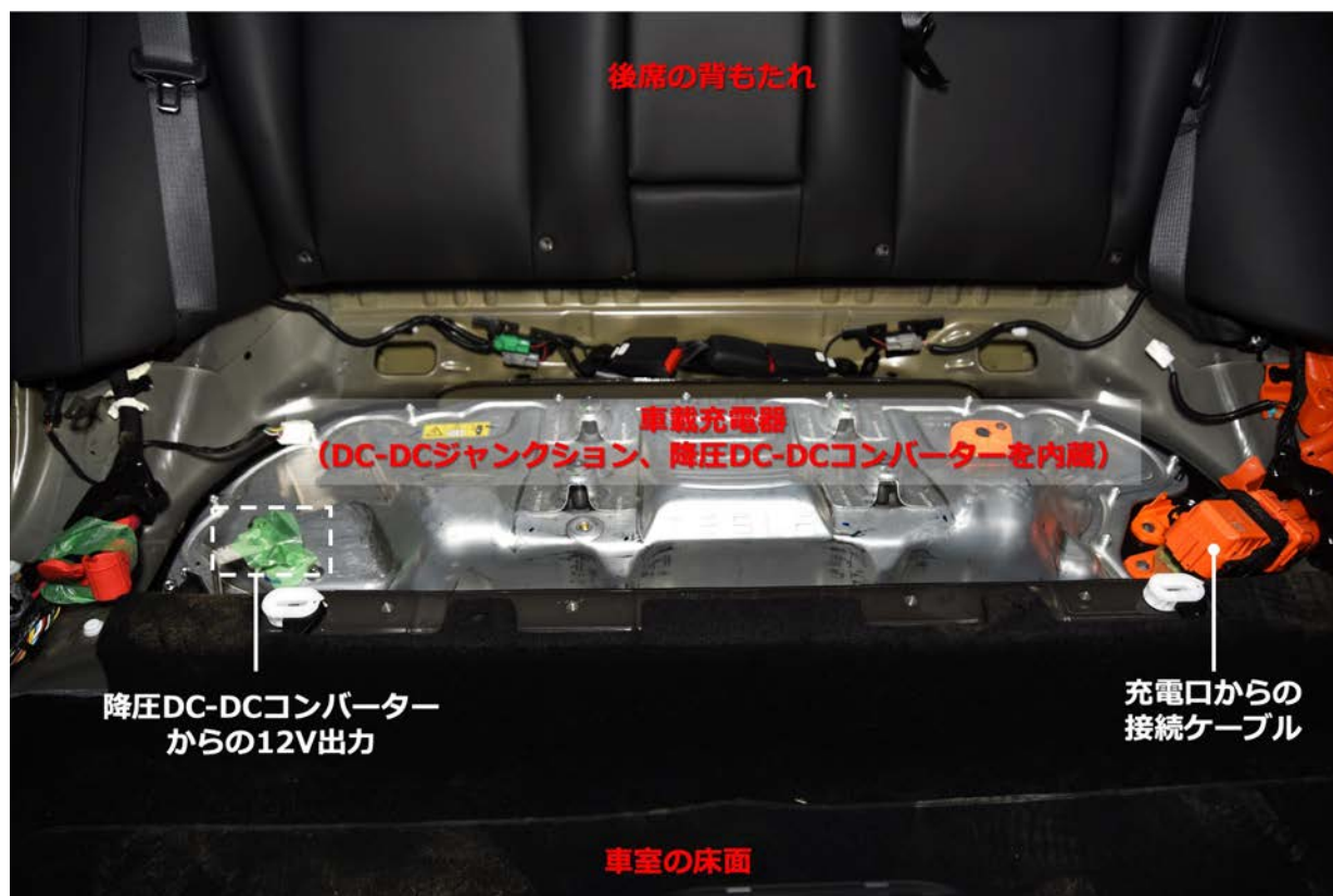
図2-2-1-5 テスラ モデル3の電池パック後方上部にある車載充電器からの電気接続
