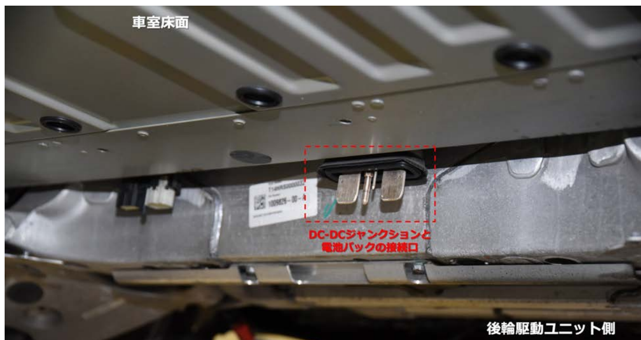
図2-2-2-3 テスラ モデルSの電池パックと電気接続する車体側の接続口
